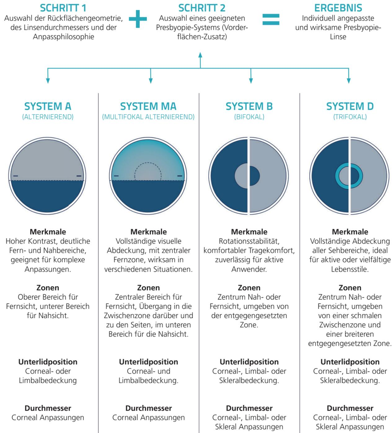
Alle Presbyopie-Systeme sind modular und können mit jedem Linsendesign kombiniert werden, einschliesslich torischer Linsen - zur Korrektur von Zylindern in allen Achslagen.
